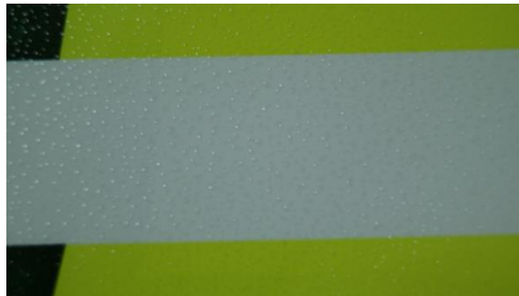
Figura 12. Burbujas por tintas abrasivas (Obtenido de Wilmer, 2016).
