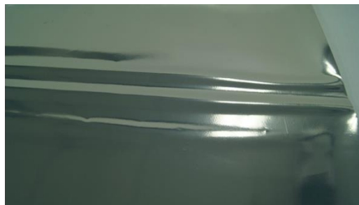
Figura 9. Rizado, canales (Bucking) (Obtenido de Wilmer, 2016).
