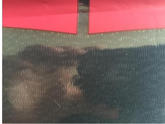
Figura 14. Burbujas al borde del área de impresión (Obtenido de Wilmer, 2016).
