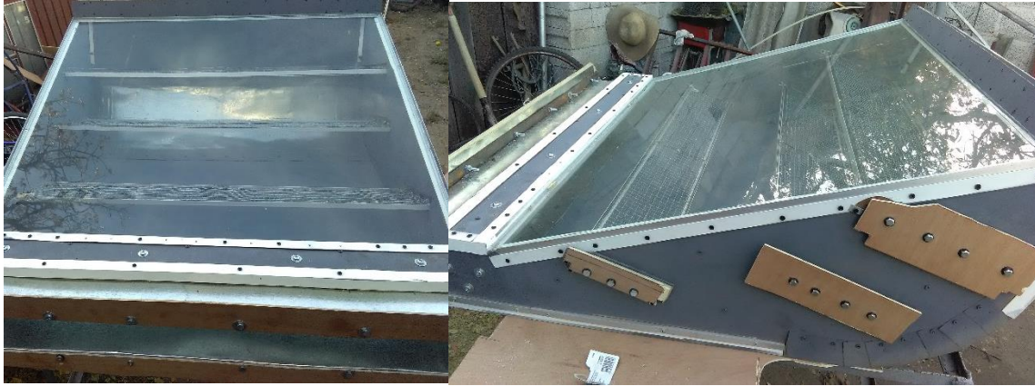
Fig.4.13. Cámara de deshidratación
