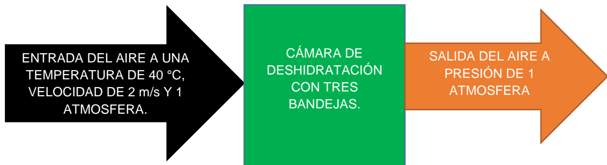
Fig. 4.5. Condiciones de entrada y salida del aire
