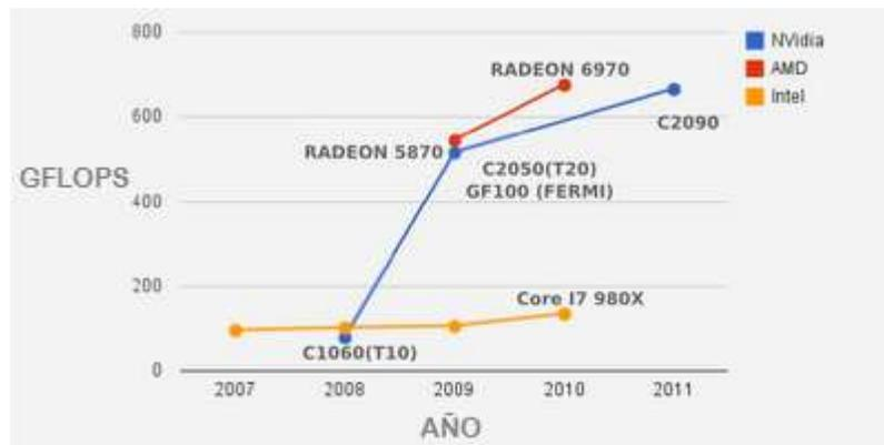
Figura 2.9 Desempeño de doble precisión en GFLOPS
