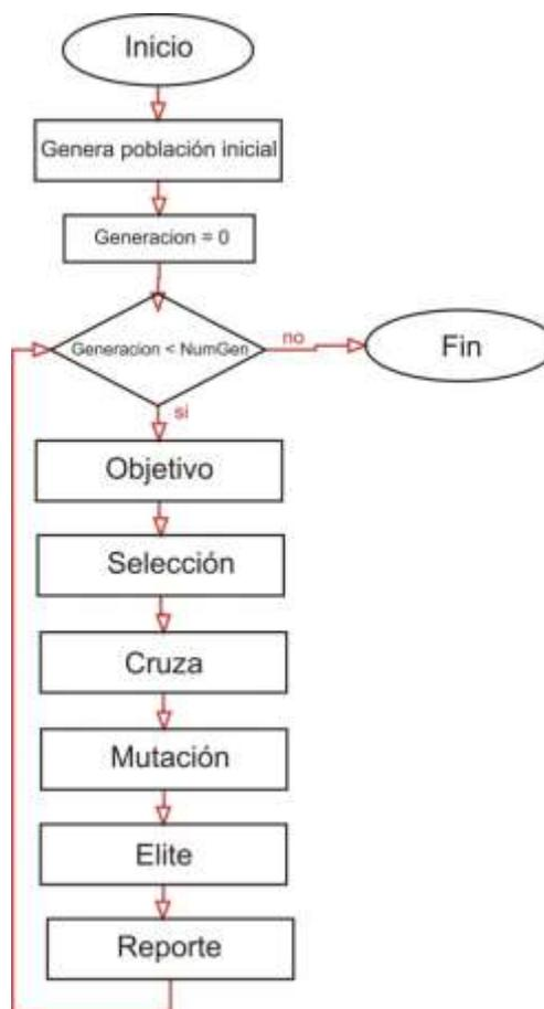
Figura 5.9 Diagrama de flujo de la función principal del algoritmo genético.
