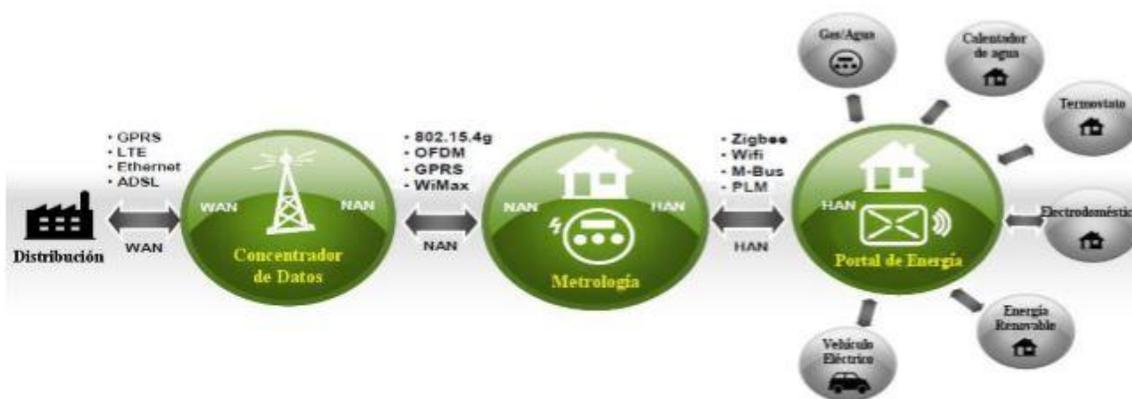
Ilustración 2. 5 Esquema de comunicación en sistemas AMI. Adaptado de (Mera, 2011).
