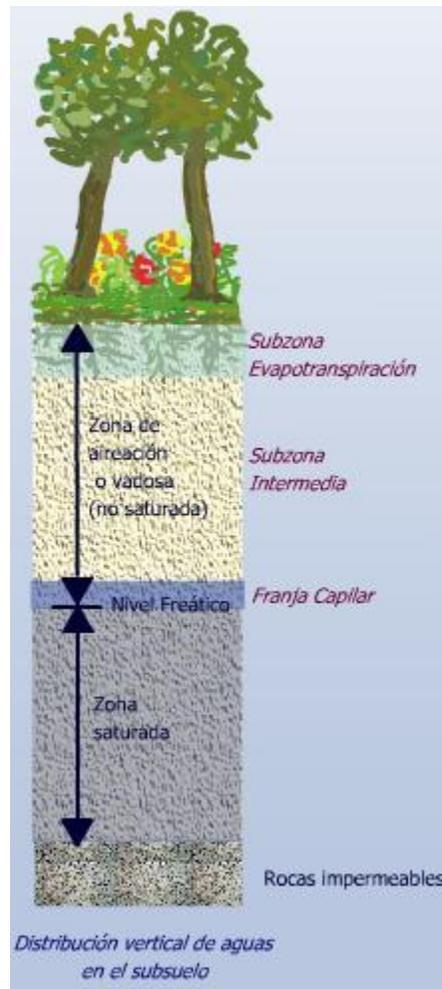
**Figura 8.** Zona vadosa o no saturada y zona saturada que distingue el transporte de contaminantes por infiltración (Univ. Complutense, 2013).
