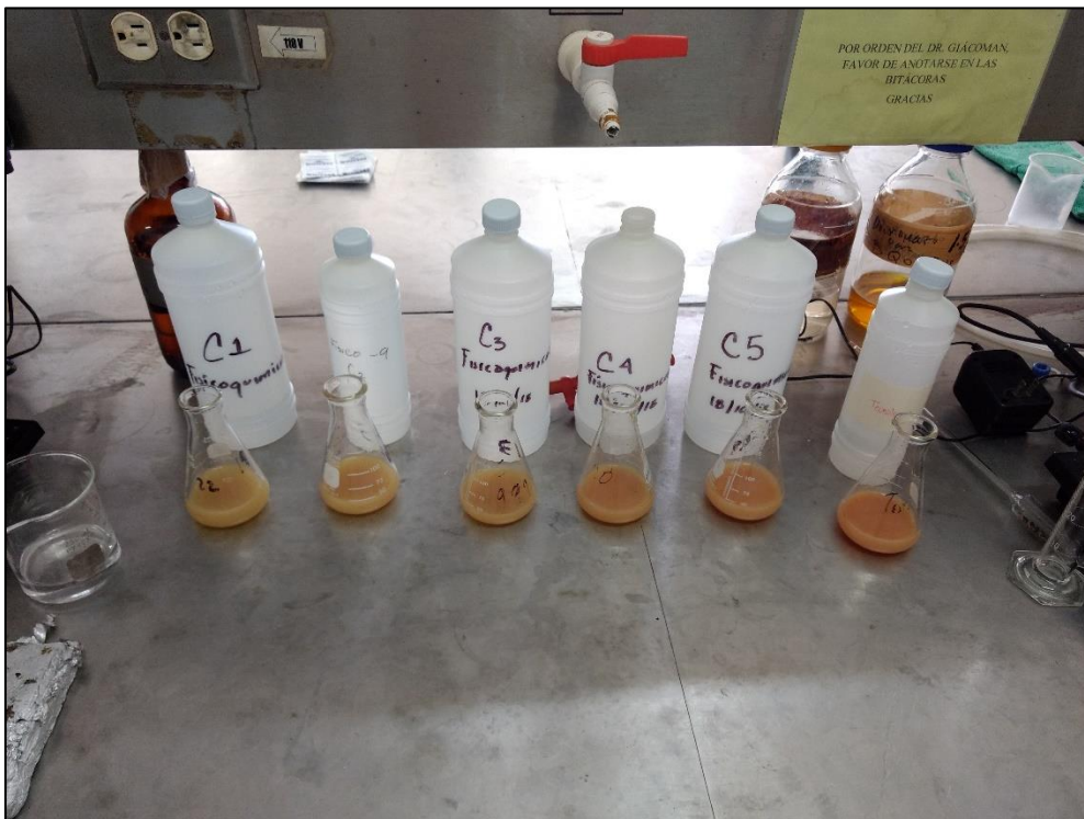
Ilustración 11. Resultados de los análisis de Cloruros de los puntos C1 al C5
