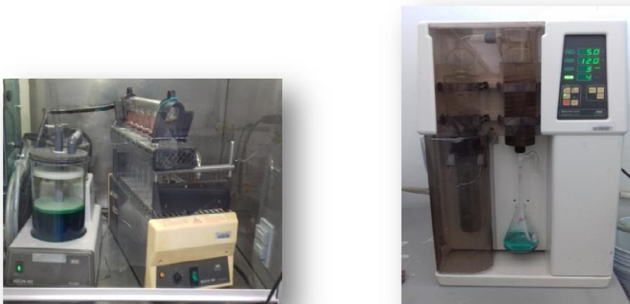
**Figura 18.** Equipo digester BÜCHI 426 y extractor de gases BÜCHI 412 (izquierda) y Unidad de destilación BÜCHI 323 (derecha)
