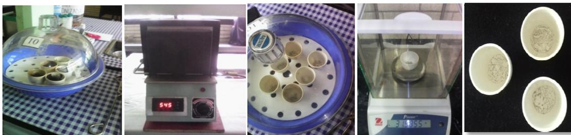
**Figura 16.** Calcinación de harinas hasta obtener cenizas
