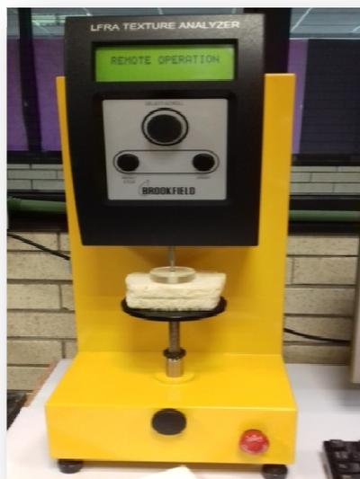
**Figura 22.** Texturómetro Brookfield LFRA (Texture Analyzer)
