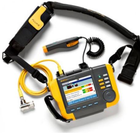
Figura 3.20. Equipo Fluke 810 Vibration Tester.
