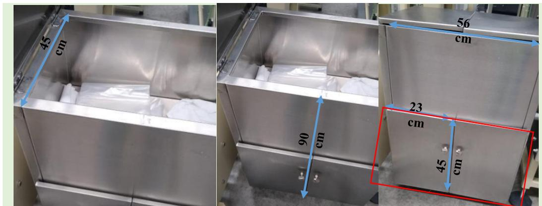
Figura 26: Rediseño implementado de contenedor de bolsas (elemento 1)
