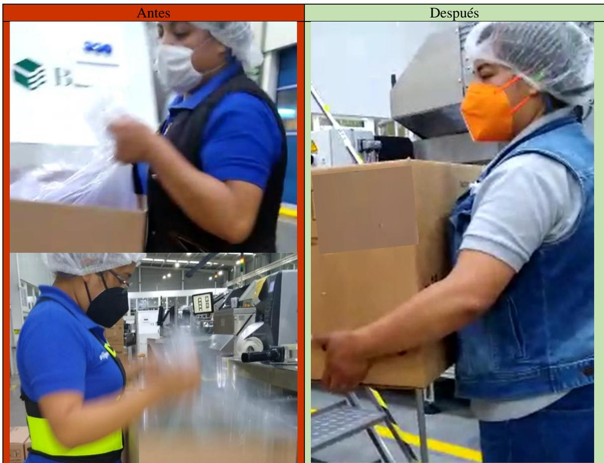
Figura 34: Mejora del puesto para garre de bolsas y colocación en báscula para pesado (Soporte metálico “elemento 3”, Soporte metálico de báscula “elemento 4”)
