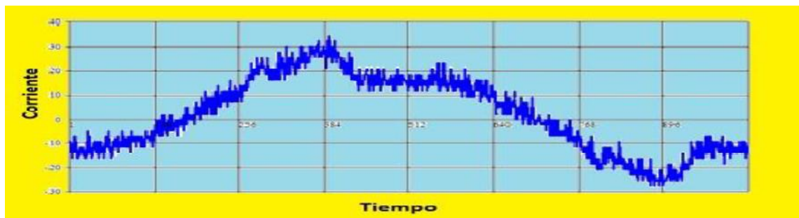
Figura 2. Forma de onda de corriente con perturbación de armónicos en la subestación eléctrica.
