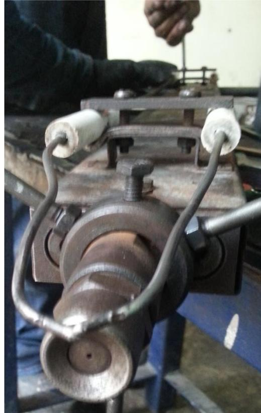
Fotografía 2.12.1.1. Calibración de electrodos Luckaut.
