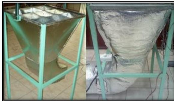
Figura 3.5. Parte interior de la tobera con cuatro deflectores y parte exterior de la tobera conectada al codo de  $90^\circ$
