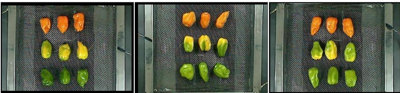
Figura 3.14. Muestras al inicio del proceso de secado a 1.75 m/s a 50, 55 y 60°C
