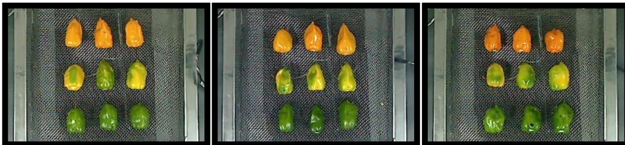
Figura 3.15. Muestras al inicio del proceso de secado a 1 m/s a 50, 55 y 60°C
