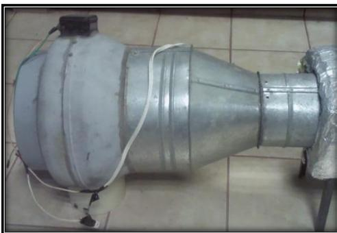
Figura 3.3. Extractor centrifugo de aire
