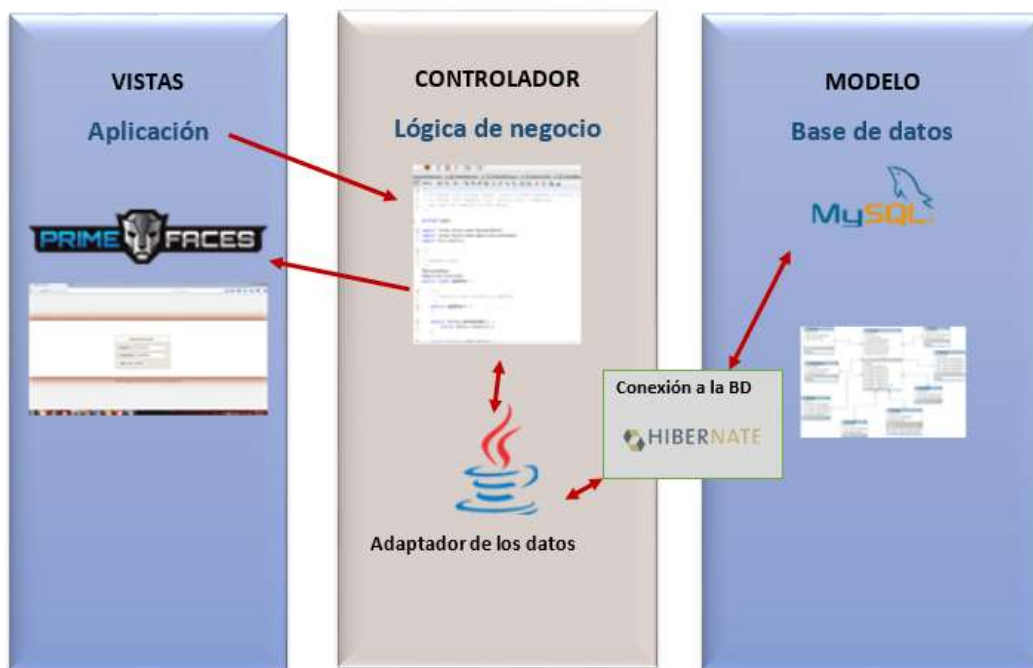
Figura 3.1 Patrón de diseño Modelo Vista Controlador
