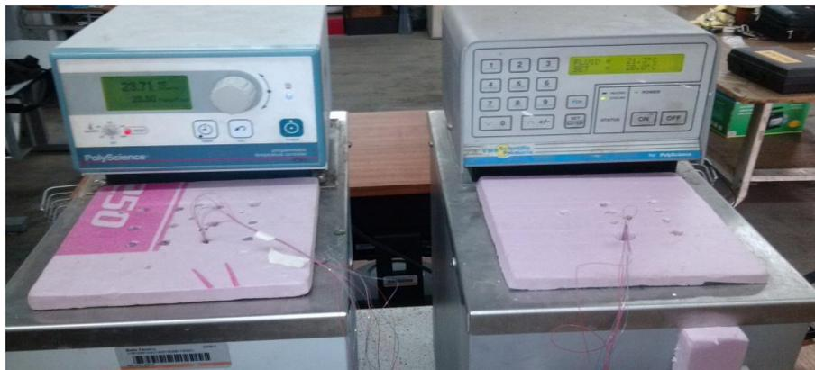
*Figura A1. Calibración de las termopilas.*
