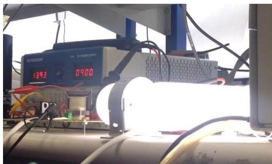
Figura 4.21 Prototipo en funcionamiento con la lámpara
