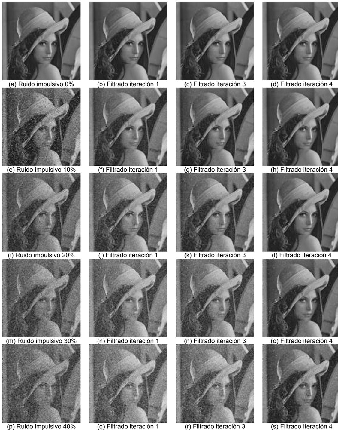
Figura 4.60 Imágenes con ruido impulsivo con probabilidad de ocurrencia de 0 a 0.4 filtradas selectivamente con el operador de mediana utilizando la salida de la red SCM
