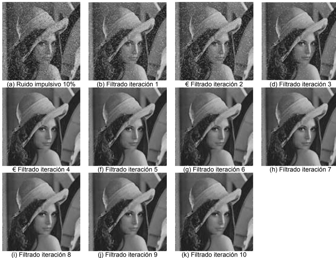
Figura 4.59 Imágenes filtradas selectivamente por el operador de mediana utilizando la salida de la red SCM
