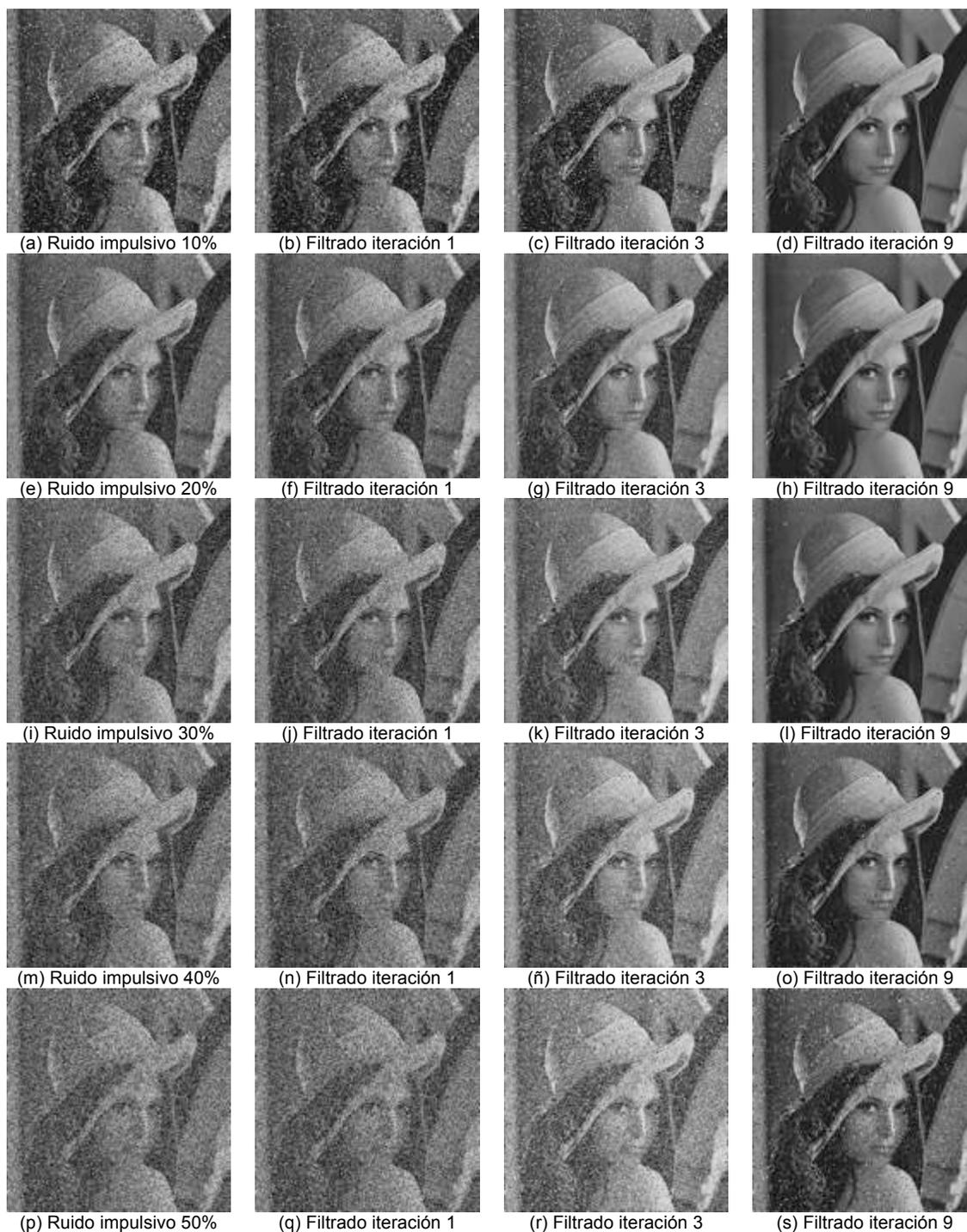
Figura 4.48 Imágenes de 0 a 50% de ruido impulsivo filtradas selectivamente utilizando la salida de la red ICM
