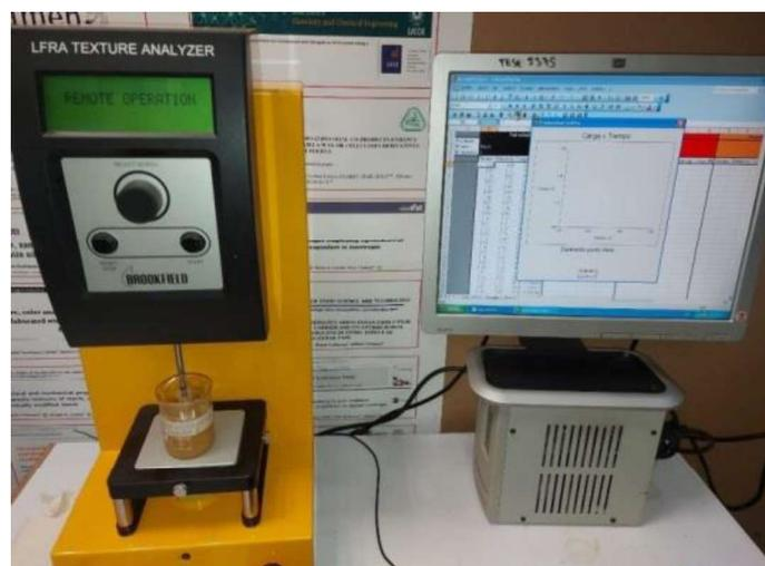
**Figura 13. Equipo “LFRA Texture Analyzer” usado en las pruebas de firmeza**
