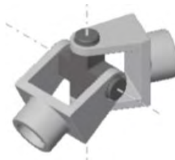
Figura 1.5. Universal, par cinemático con 2 GDL [1].
