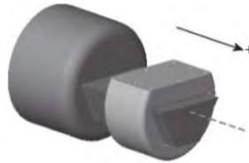
Figura 1.4. Prismático, par cinemático con 1 GDL [1].
