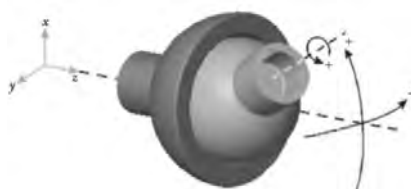
Figura 1.7. Esférica, par cinemático con 3 GDL [1].
