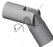
Figura 1.3. Revoluta, par cinemático con 1 GDL [1].
