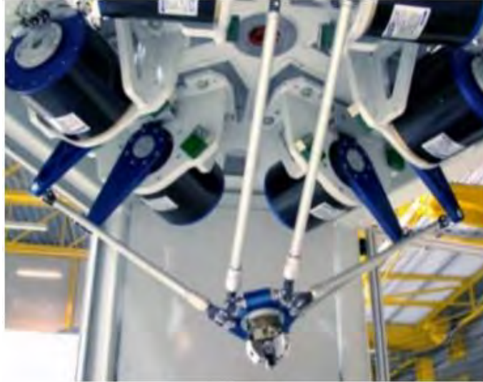
Figura 1.2. Robot o manipulador paralelo Tipo-Delta, conformado por tres cadenas cinemáticas cerradas [3].
