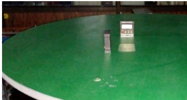
Figura 3.67. Nivelómetros colocados en la base móvil.
