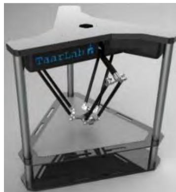
Figura 1.19. Robot paralelo tipo delta de 3 GDL [15].
