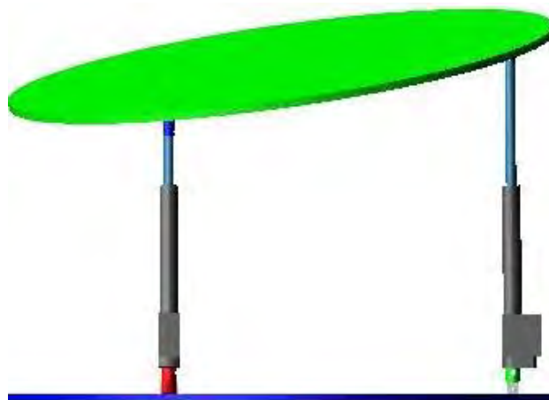
Figura 3.10. Vista lateral del robot paralelo 3-RPS después de la simulación.
