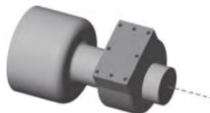
Figura 1.6. Cilíndrico, par cinemático con 2 GDL [1].
