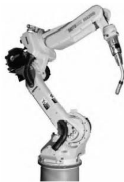
Figura 1.1. Robot tipo serie, conformado por una cadena cinemática abierta [2].
