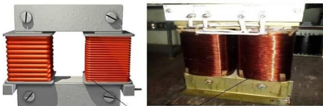
Figura 49. Bobinas (devanados) del transformador
