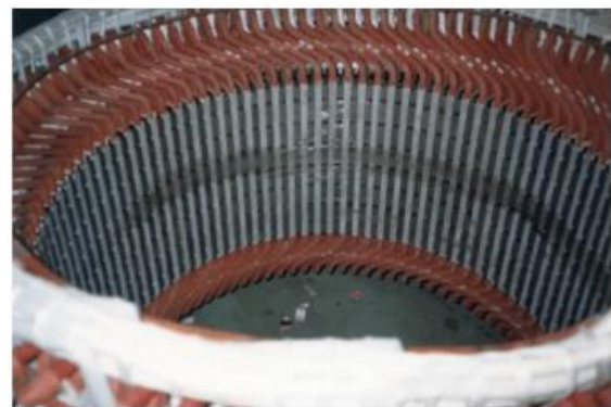
Figura 137. Estator de generador síncrono
