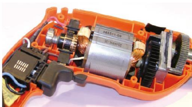
Figura 199. Motor monofásico universal para un taladro eléctrico
