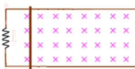
Figura 29. Vista superior de la fem inducida en un conductor
