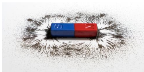
Figura 5. Los campos magnéticos son dipolares, poseen un polo Norte y un polo Sur
