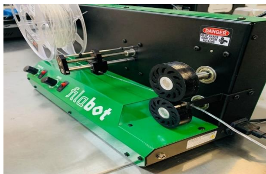
Figura 51 Embobinador, complemento final a Filabot del tecnológico
