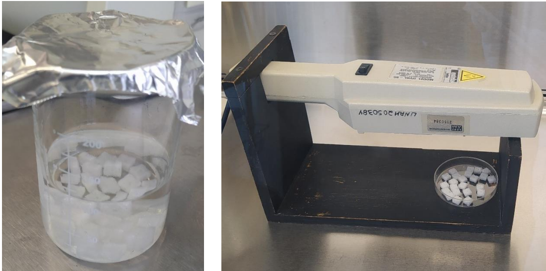
Figura 41 Proceso de inmersión en etanol para esterilización y lámpara de luz ultravioleta
