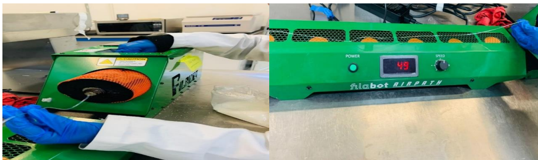
Figura 50 Equipo Filabot, extrusor y aireador de filamento polimérico para biomateriales empleado en el Tecnológico
