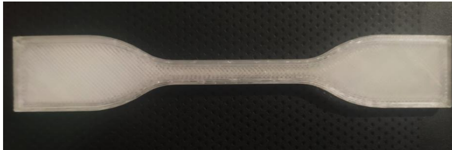
Figura 63 Probeta para prueba de tensión de concentración 0% nHAp
