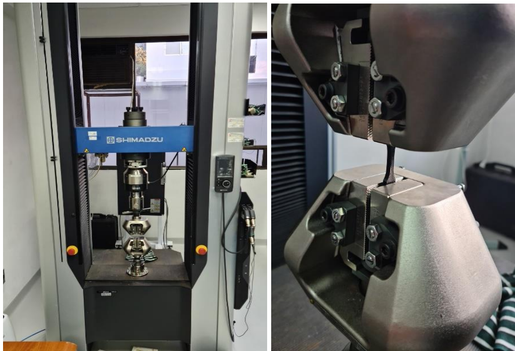
Figura 29 Equipo para pruebas de Tensión en CIDESI
