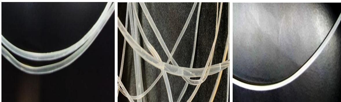
Figura 60 A la izquierda filamento blando PLA, al centro BAJnHAp y a la derecha ALTnHAp
