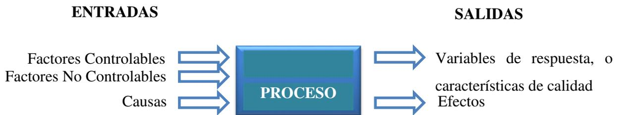
**Fig. 2.1 Variables de un proceso.**
