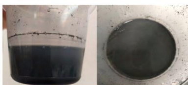
Figura 4.- Composito elaborado a base de las dispersiones de nanotubos de carbono de pared simple.
