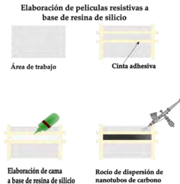
Figura 2.- Rocío de las dispersiones sobre sustratos a base de resina de silicio.
