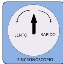
La aguja giratoria muestra la diferencia entre las dos fases homónimas, si la aguja está alineada verticalmente indica que los sistemas estén en fase y puede entrar en paralelo. Si el generador entrante es más rápido que el sistema en funcionamiento, entonces el ángulo de fase aumenta y las agujas del sincronoscopio rotan en sentido de las manecillas del reloj, si el generador entrante es más lento que el sistema la aguja del sincronoscopio rotara en sentido antihorario.
