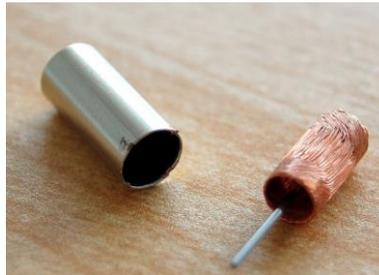
La estructura del motor sin núcleo (también llamado de copa hueca) rompe la estructura del rotor del motor tradicional, adoptando el rotor sin núcleo, también conocido como rotor de copa hueca. La nueva estructura del rotor elimina completamente la pérdida de potencia causada por la corriente parásita formada por el núcleo de hierro.
