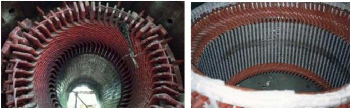
El conjunto de devanados aislados se coloca dentro de la ranura del núcleo del estator como se muestra en la *Figura 8*. Los tres juegos de devanados, uno para cada fase conectado en estrella. El área de la sección transversal de estos devanados debe ser suficiente para transportar la corriente nominal de la máquina.
