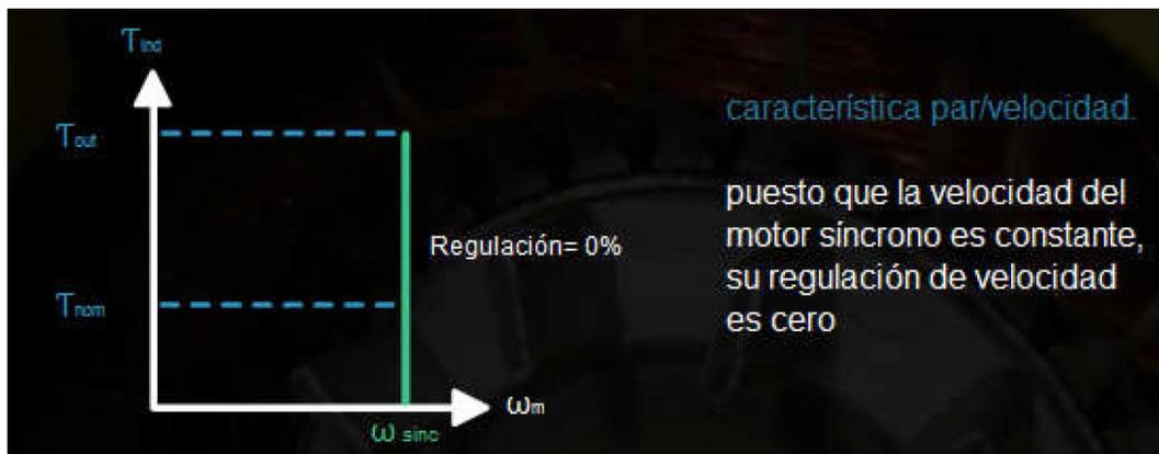
La velocidad de estado estacionario del motor es constante desde vacío hasta el par máximo que puede suministrar el motor, tal que la regulación de velocidad de este motor es 0%. La ecuación del par es:
