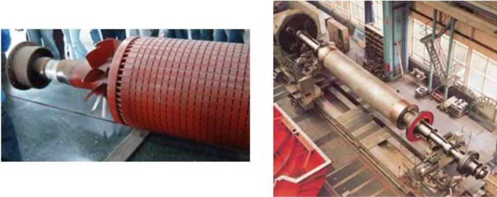
Por lo tanto, está particularmente bien adaptado para máquinas eléctricas de alta velocidad son máquinas de pocos números de polos (2 o 4), tal como los generadores de turbinas a vapor o turbogeneradores, que se utilizan en las centrales térmicas o similares. El devanado de campo está distribuido en varias bobinas situadas en diferentes ángulos.
