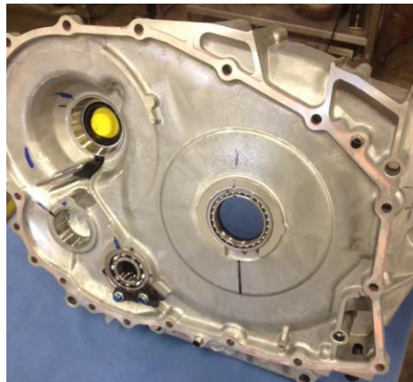
Figura 2-26. Pieza de aluminio maquinada después de ser fundida.
