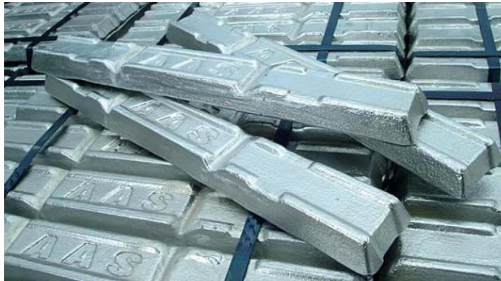
Figura 2-21. Lingotes de aluminio formados por un proceso de fundición.
