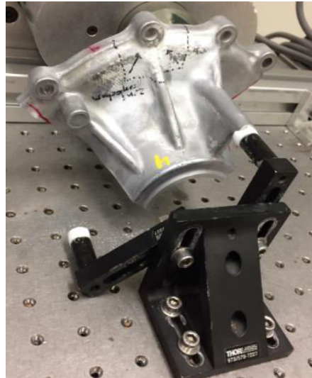
Figura 3-3. Jig de sujeción para partes de prueba.
