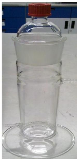
Fig. 7. Diseño de reactor para fotocatalisis.
