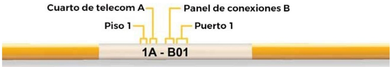
**Figura 28 Etiquetado del cableado**
