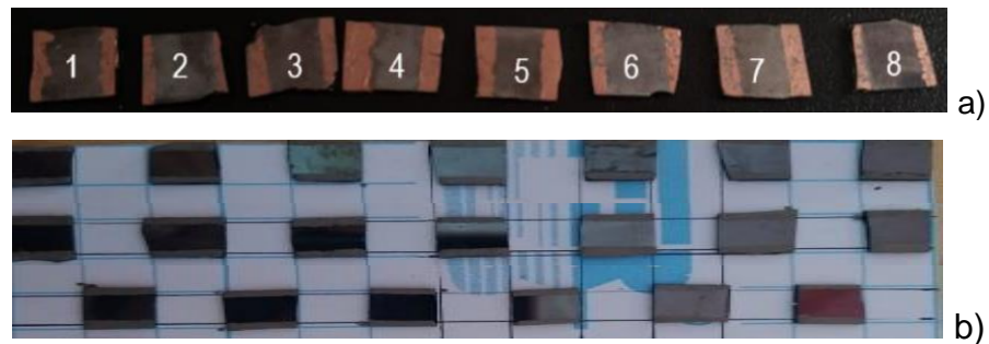
Figura 39. a) Primeros Foto-resistores preparados, b) Foto-resistores de PbS acondicionados por un método manual con contactos de pintura conductiva de Cu, Ag y Pt.
