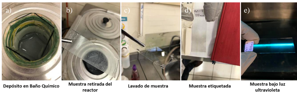
Figura 24. Preparación de película delgada desde la deposición dentro de la cámara de reacción a través de extracción, lavado y etiquetado.
