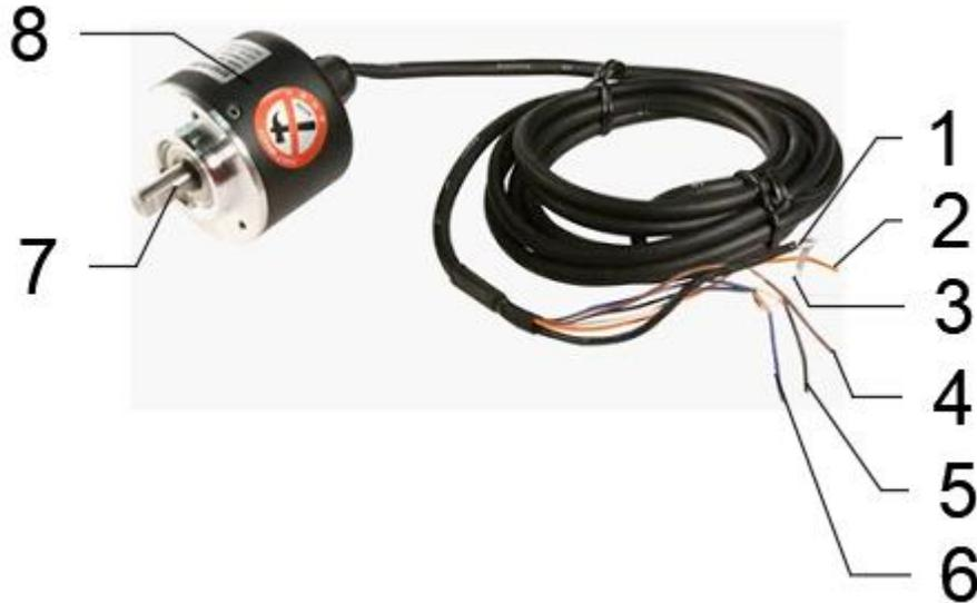
Figura 16. 1) Negro: out A 2) Anaranjado: out Z 3) Blanco: out B 4) Café: +V 5) Shield: F.G 6) Azul: 0V 7) Eje 8) Carcasa
