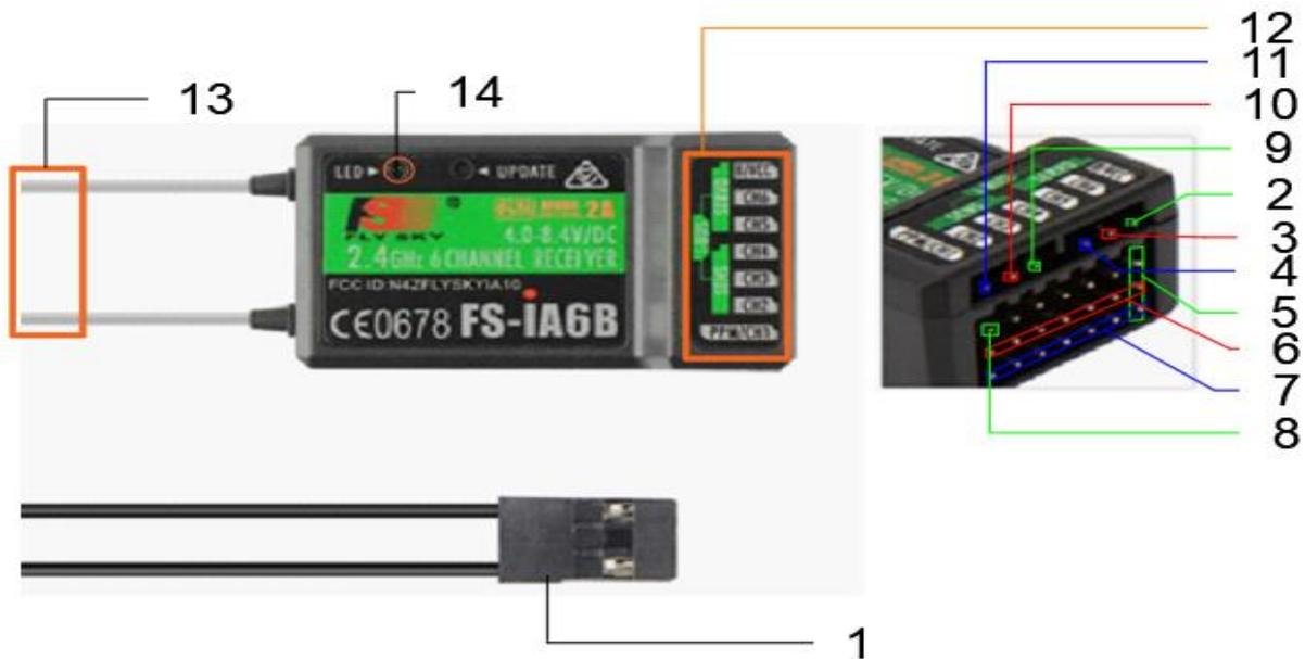
Figura 14. 1) puente para brindar o sincronizar a un control remoto 2) Puerto serial RX IBUS 3) VCC de RX IBUS 4) GND de IBUS 5) Conexión del puente Bin 6) Pines VCC 7) Pines GND 8) Puerto PPM con los pines de inferiores se energiza 9) Puerto serial TX IBUS 10) VCC TX IBUS 11) GND TX IBUS 12) Diagrama para ubicar los canales 13) Antena 14) Led indicador de estado
