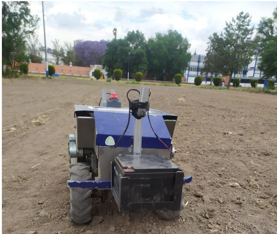
Figura 42. Robot agrícola con batería auxiliar
