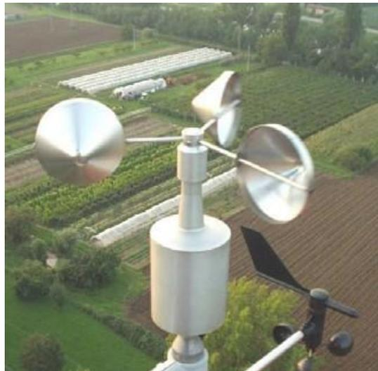
*Figura 10 Torre de medición con anemómetro y veleta.*
