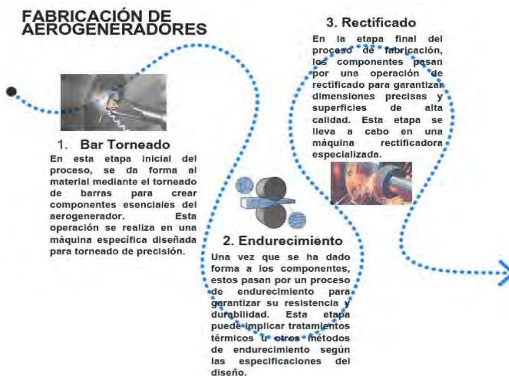
Figura 13 Proceso de fabricación de aerogeneradores
