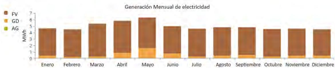
**Figura 23.** Energía producida por cada elemento de generación.
