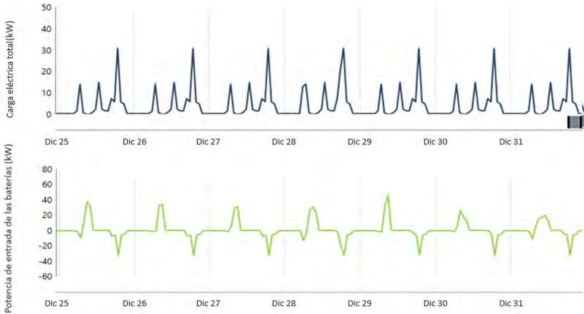
**Figura 31.** Estados de carga y descarga del sistema de baterías.
