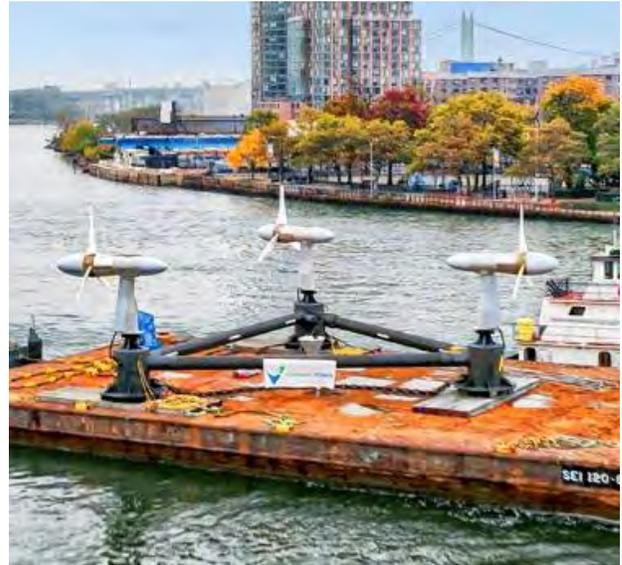
**Figura 5.** Turbinas de sistema de flujo libre Gen5 instalada en el East River de la ciudad de Nueva York [11].
