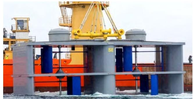
**Figura 6.** Turbina de eje vertical de 1 MW instalada en el emplazamiento de pruebas de Paimpol-Bréhat (Bretaña) [11].
