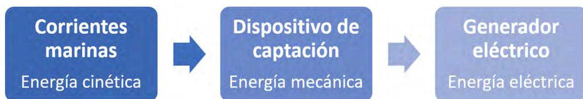
**Figura 1.** Esquema general de conversión de energía por corrientes marinas.
