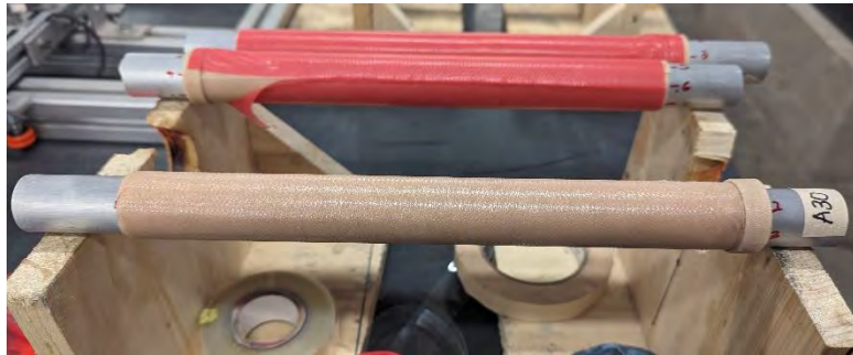
Figura D.15 Tira de para facilitar la extracción del molde
