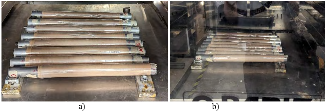
Figura D.18 Tubos en el horno: a) Colocación dentro del horno, b) Horno cerrado (precalentado)
