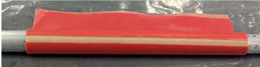
Figura D.12 Empalme en la capa 4 e inicio de colocación de la capa 5
