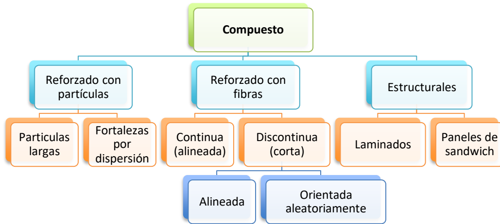
Figura 2.4 Clasificación de los materiales compuestos, según el tipo de refuerzo [15]
