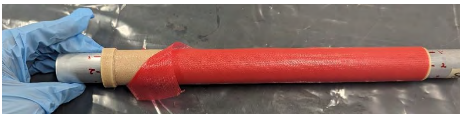
Figura D.14 Colocación de la tira de 7mm en el costado del tubo laminado
