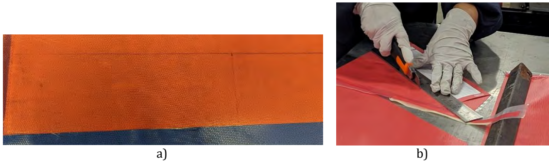
Figura D.3 Proceso de corte de la fibra de vidrio prepreg: a) Marcación de la fibra para recortar , b) Corte de la fibra
