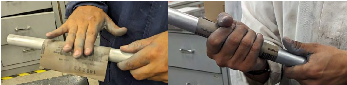
Figura D.2 Proceso de lijado y limpieza de los moldes
