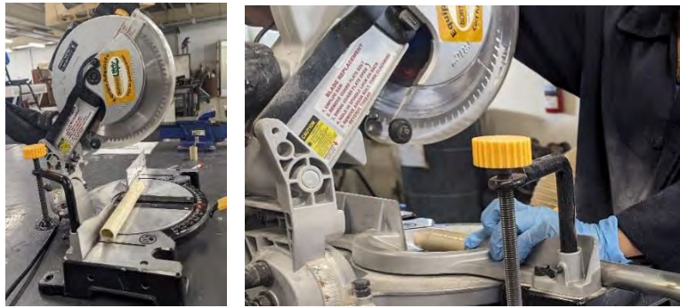
Figura D. 23 Proceso de corte del tubo: a) Posición del tubo en la cortadora , b) Verificar antes de cortar
