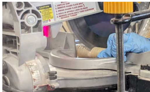
Figura D.24 Corte de las probetas
