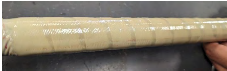
Figura D.21 Retiro del sobrante de la cinta de poliéster
