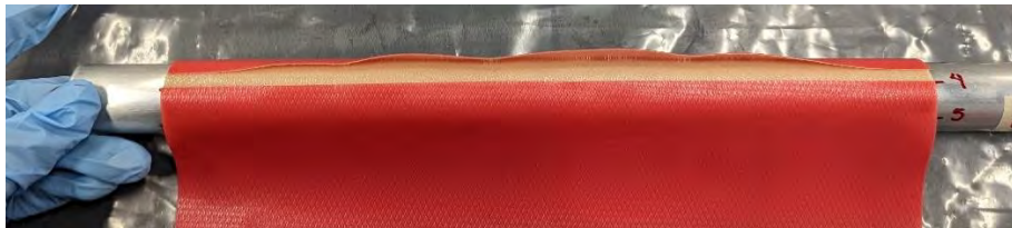
Figura D.13 Distribución de los empalmes al enrollar la fibra prepreg
