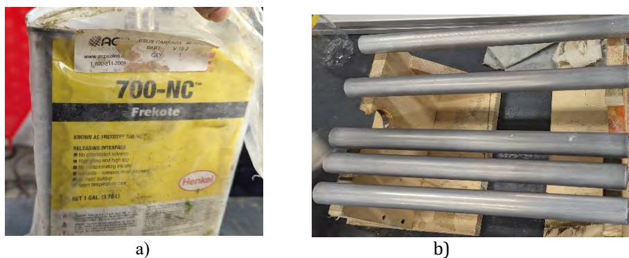
Figura D.6 Aplicación del líquido desmontable: a)Líquido desmontable, b)Moldes con el líquido
