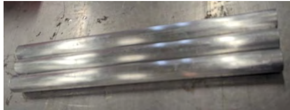
Figura D.1 Tubos de aluminio utilizados como moldes para el proceso de preimpregnado
