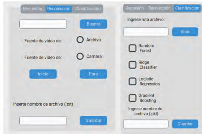
Figura 3. 9 Ventana de clasificación para selección de entrada de video y recolección de datos, así como para la selección de modelo de clasificación
