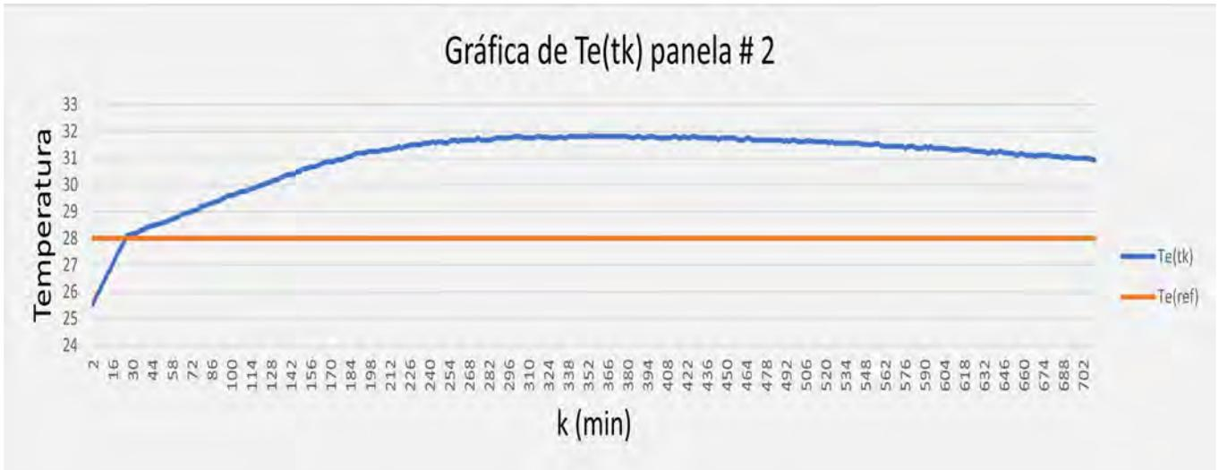
Fig. 5.7. Datos obtenidos de temperatura durante la fermentación de panela # 2.
