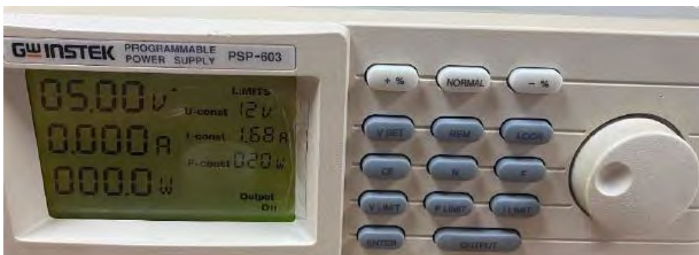
Figura 30 Fuente de alimentación 60 V- 3.3 A.
