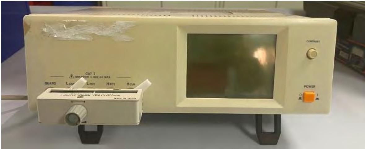
Figura 16 Medidor de inductancia, capacitancia y resistencia marca EDIBON mod. ED-MLCR01.
