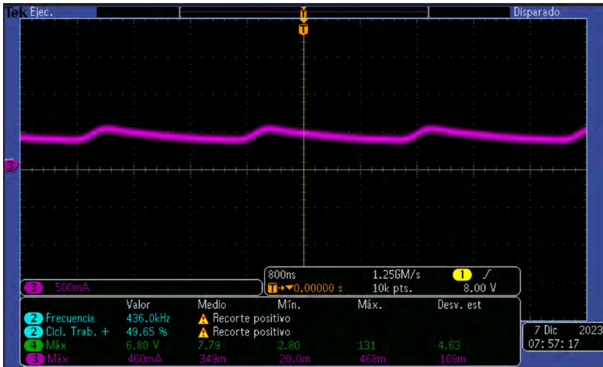
Figura 34 Corriente en la carga de 460 mA.
