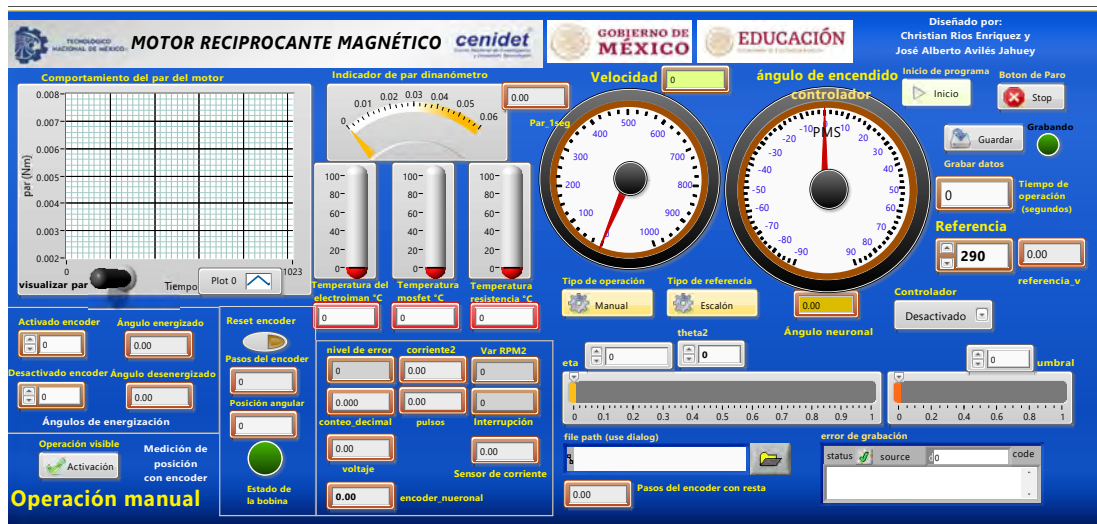
Figura 4.5. Plataforma de monitoreo y operación del MRM en LabVIEW.
