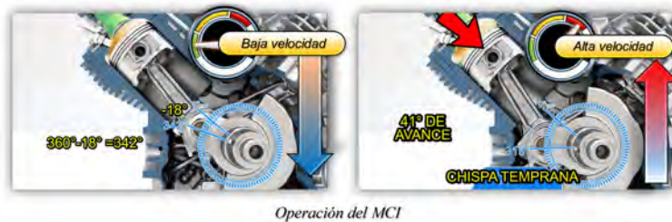
Figura 4.2. Momentos de generación de chispa para la operación del MCI.
