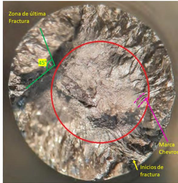
Figura 7.6: Superficie de fractura dúctil de la probeta T4.
