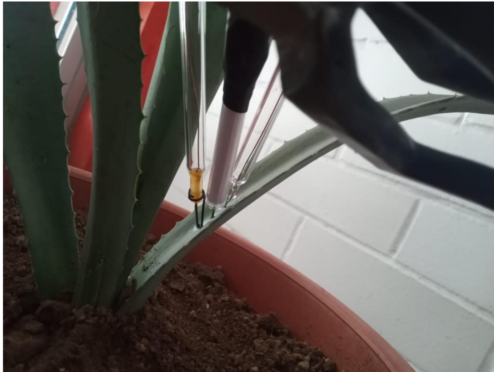
Figura 7. Ubicación de los electrodos en la hoja del Agave angustifolia Haw.
