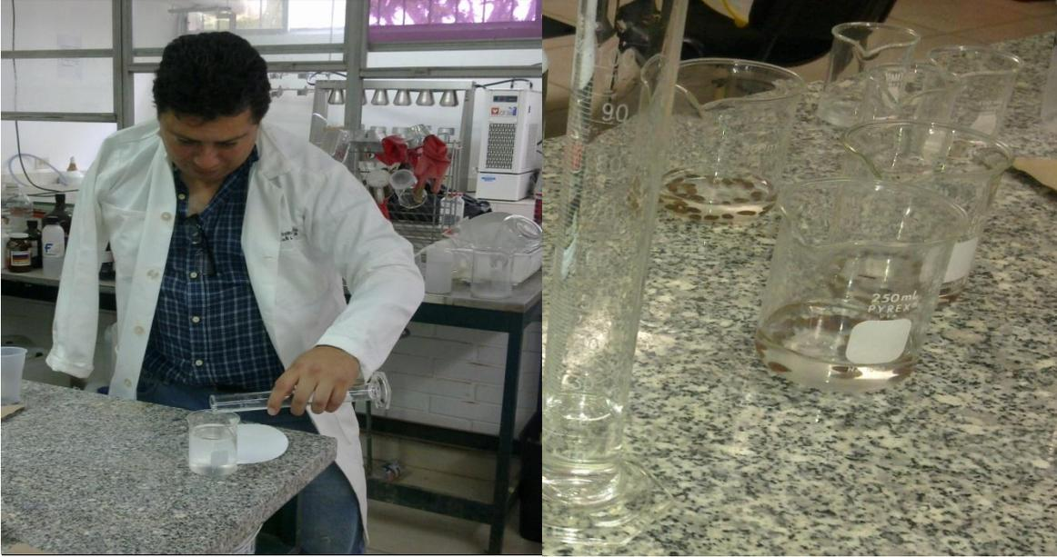
Figura 20. Escarificación con ácido clorhídrico en concentración 20%, 50%, tiempos de exposición de (sumergir y sacar) de 15 y 30 minutos.
