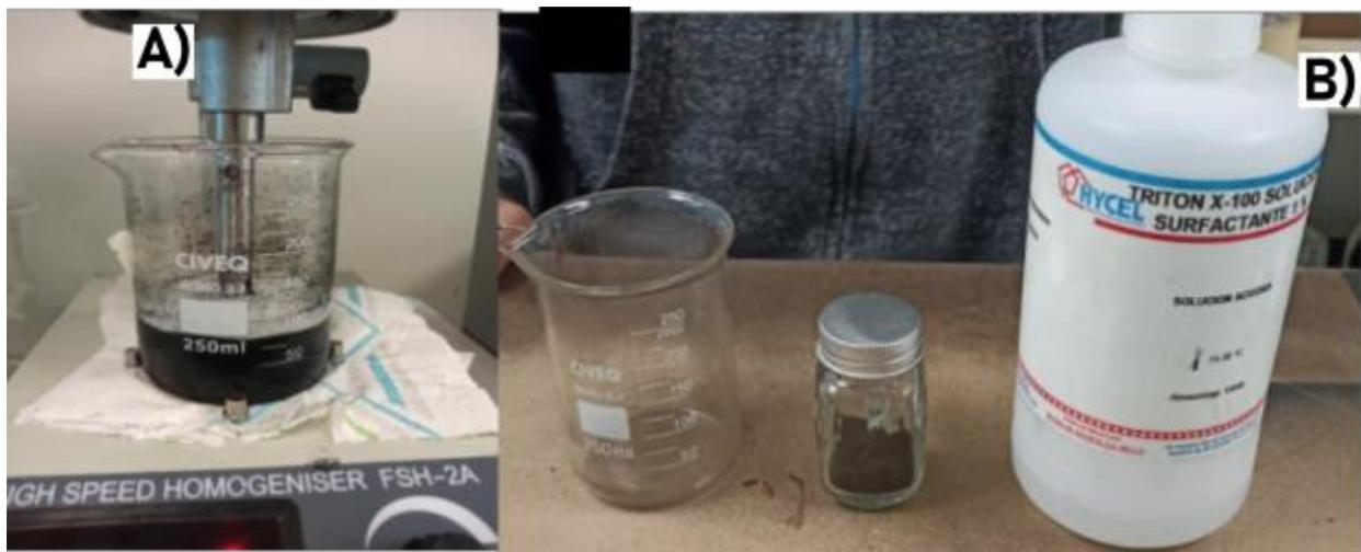
**Figura 25. Materiales utilizados en la dispersión de nanotubos de carbono.**
