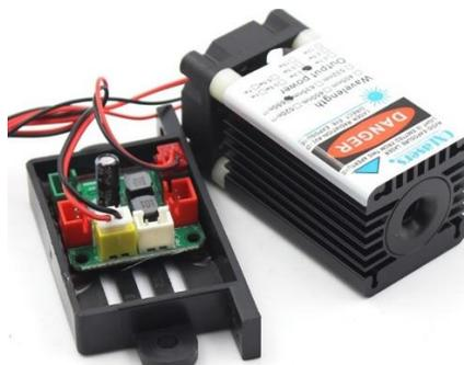
**Figura 19. Láser verde 520 nanómetros (nm) Oxlasers.
