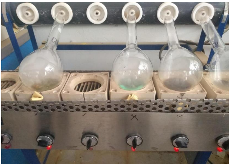
Figura 7. Determinación de proteína de la harina de Pez Diablo Hypostomus plecostomus en aparato Kjeldahl
