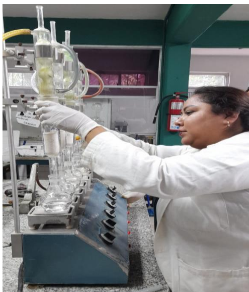
Figura 8. Determinación de extracto etéreo
