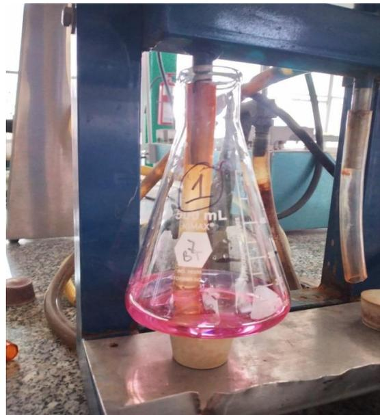
Figura 20. Separación de nitrógeno de mezcla digerida
