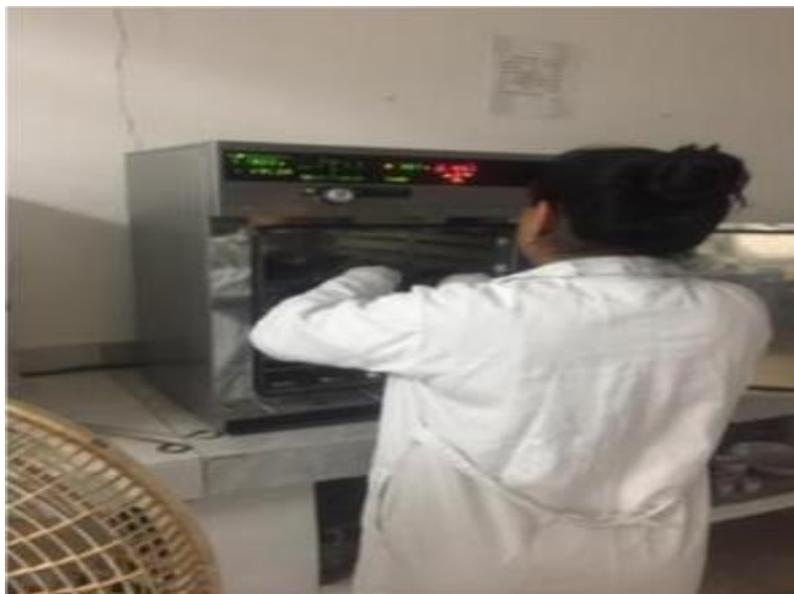
Figura 12. Regularización de temperatura a 60° en horno de secado
