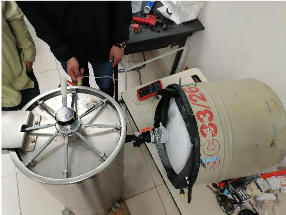
Figura 3.13 Censado de temperatura en cámara criogénica
