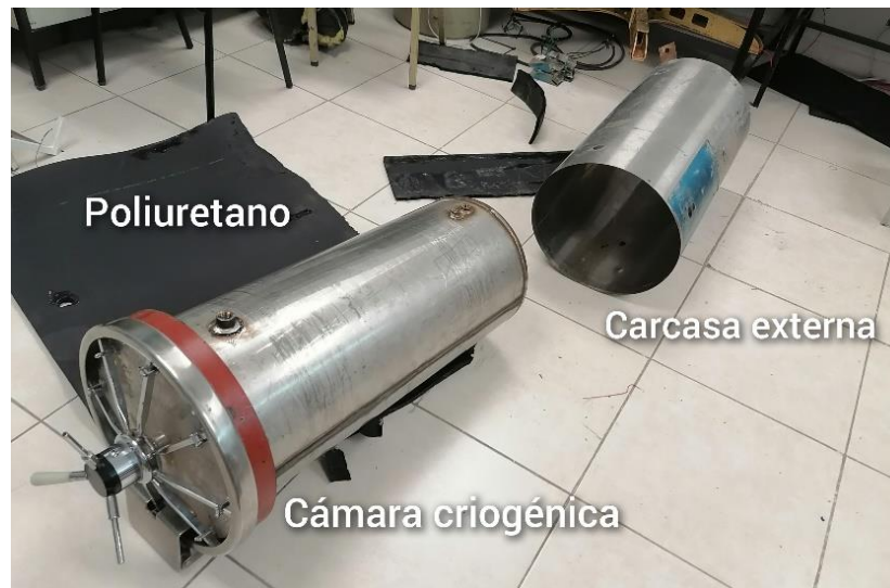
Figura 3.8 Instalación de aislamiento térmico
