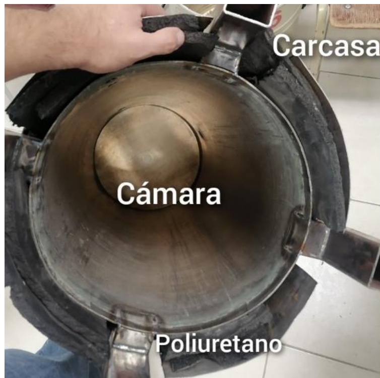
Figura 3.9 Aislamiento térmico instalado
