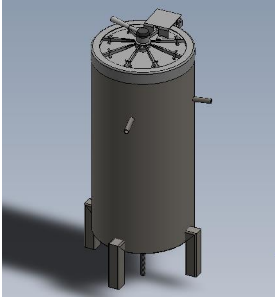
Figura 3.2 Representación gráfica de criocongelador elaborado mediante el software SOLIDWORKS®
