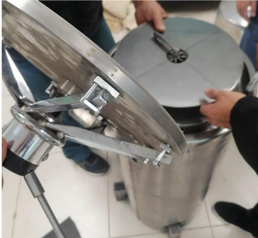
Figura 3.10 Instalación del émbolo en equipo criogénico
