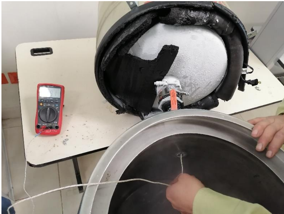
Figura 3.12 Censado de temperatura en depósito de nitrógeno
