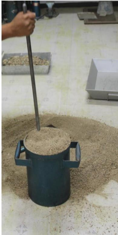
**Figura 38. Penetraciones del agregado fino.**
