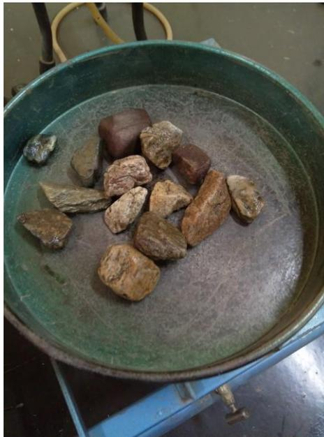
**Figura 54. Secado del agregado grueso**
