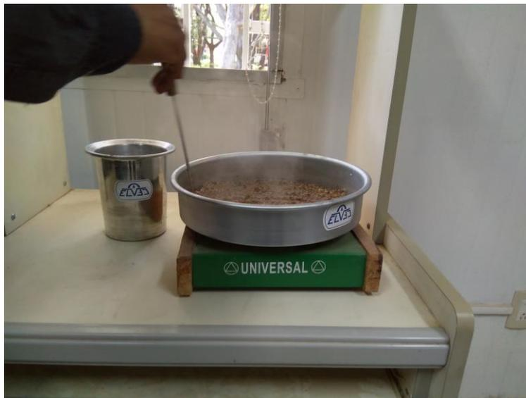
**Figura 48. Secado del agregado fino.**
