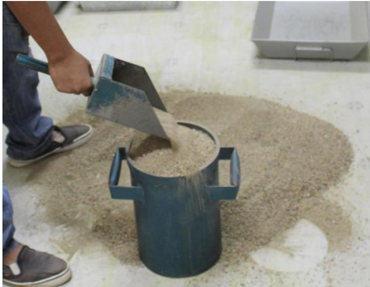
**Figura 31. Llenado del agregado fino.**
