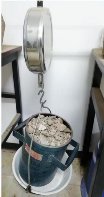
**Figura 29. Peso del agregado grueso.**
