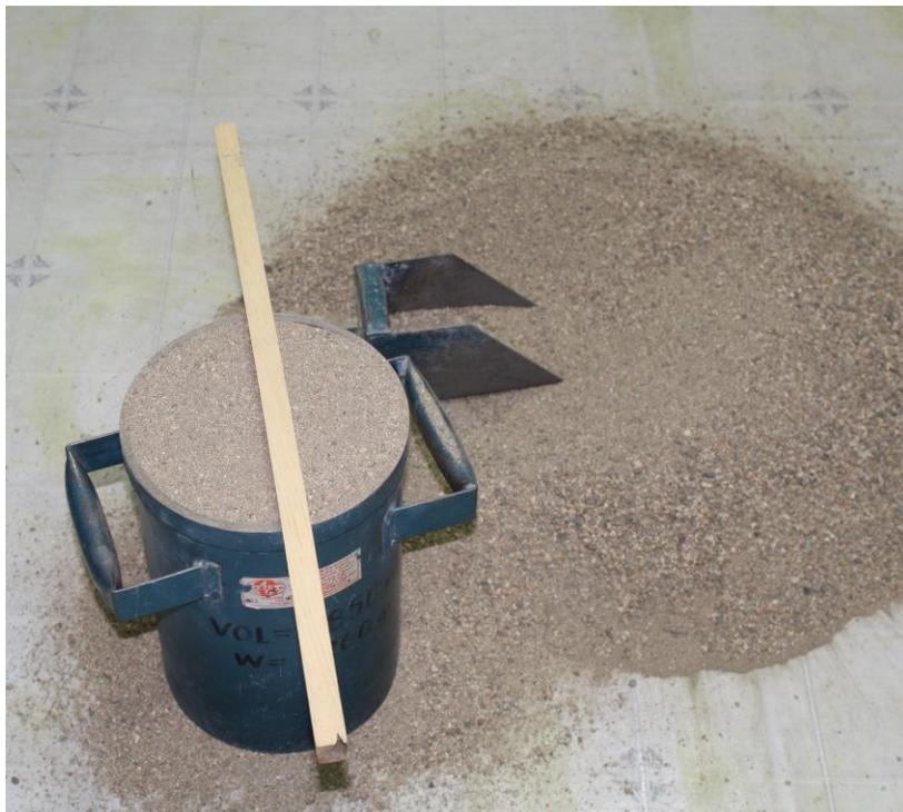
**Figura 39. Enrazado del agregado fino.**
