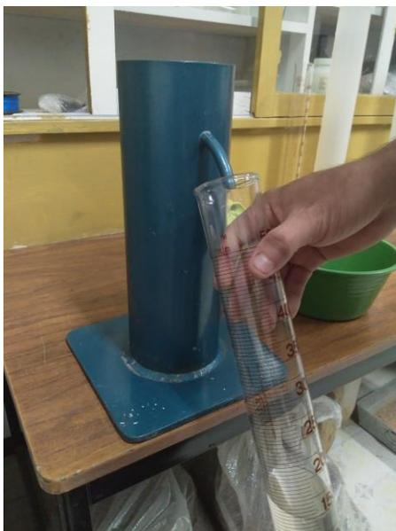
**Figura 45. Picnómetro tipo sifón vertiendo agua en la probeta.**
