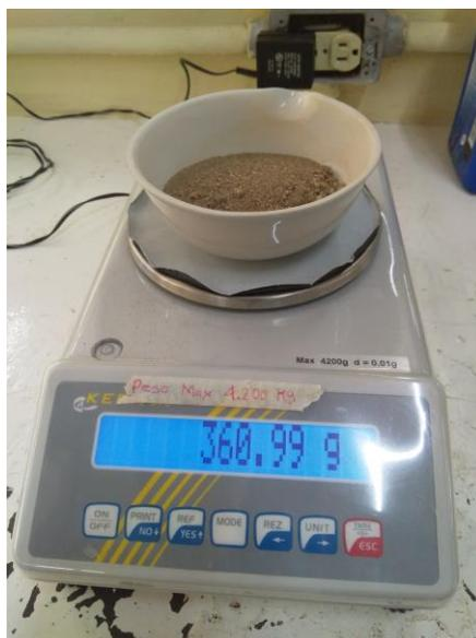
**Figura 57. Peso del agregado fino.**
