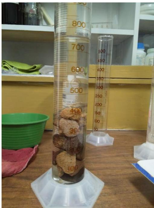
**Figura 44. Probeta con agregado grueso.**
