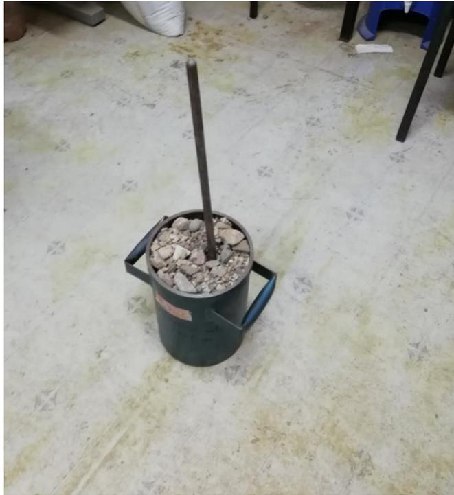
**Figura 35. Penetraciones del agregado grueso.**
