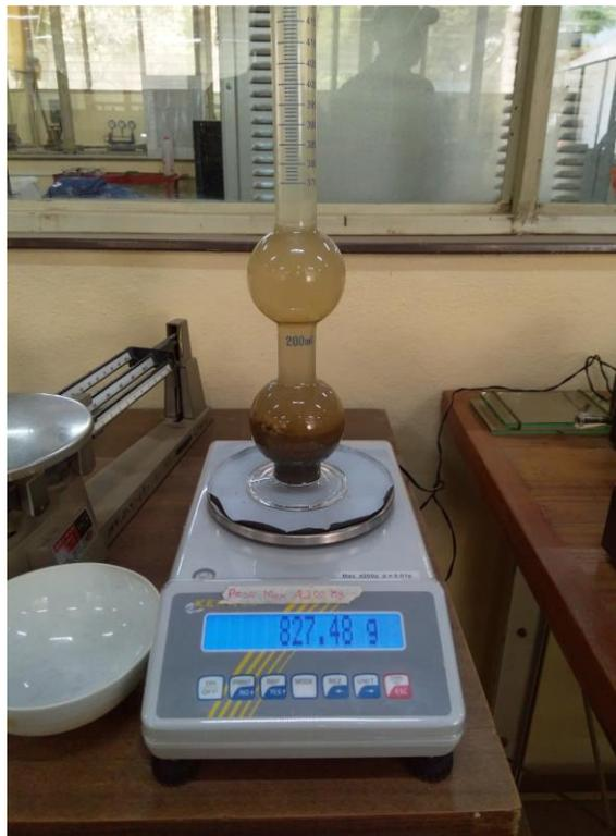
**Figura 52. Peso del frasco chapman con agregado fino y agua.**
