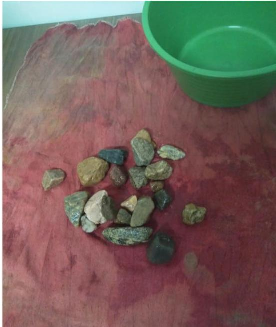
**Figura 42. Secado del agregado grueso.**
