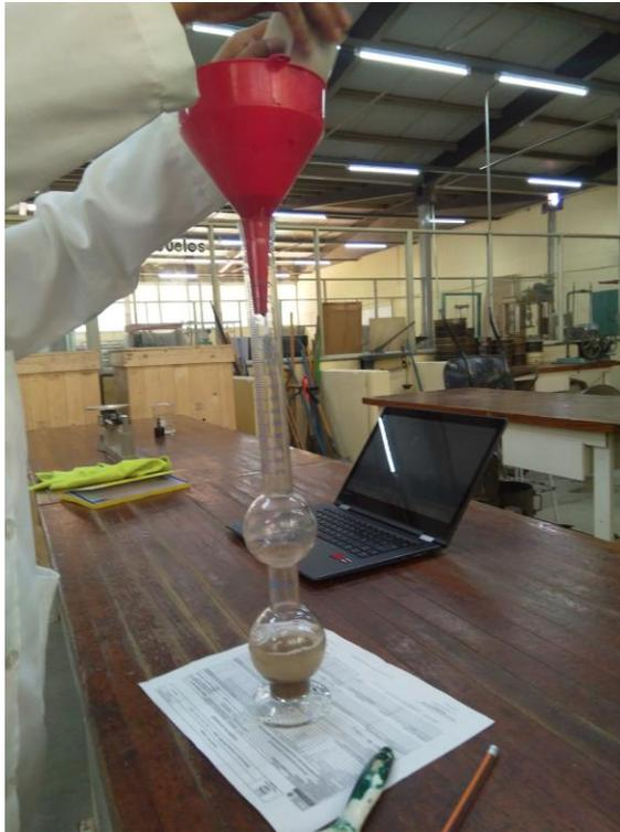
**Figura 51. Vertido del agregado fino.**
