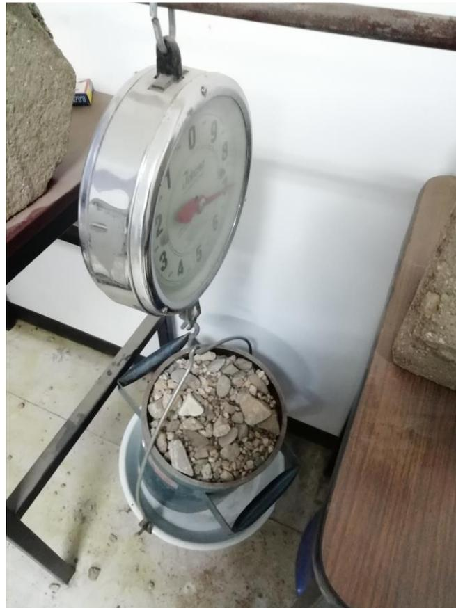
**Figura 36. Peso del agregado grueso.**
