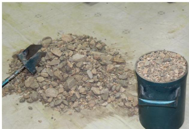
**Figura 28. Llenado del agregado grueso.**
