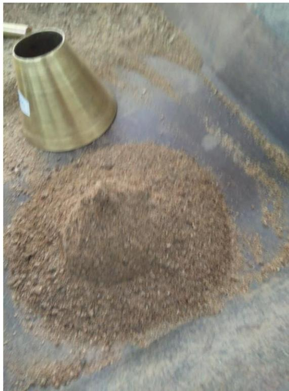
**Figura 50. Arena que tiene grado superficialmente seco.**
