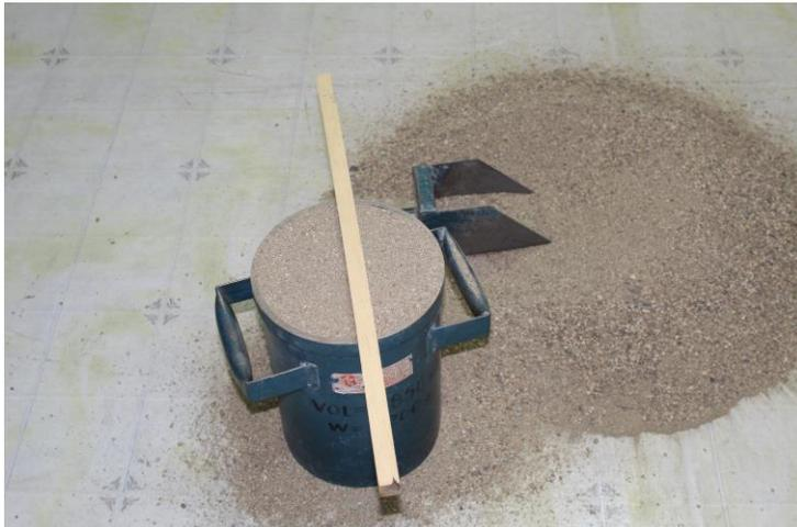
**Figura 32. Enrazado del agregado fino.**
