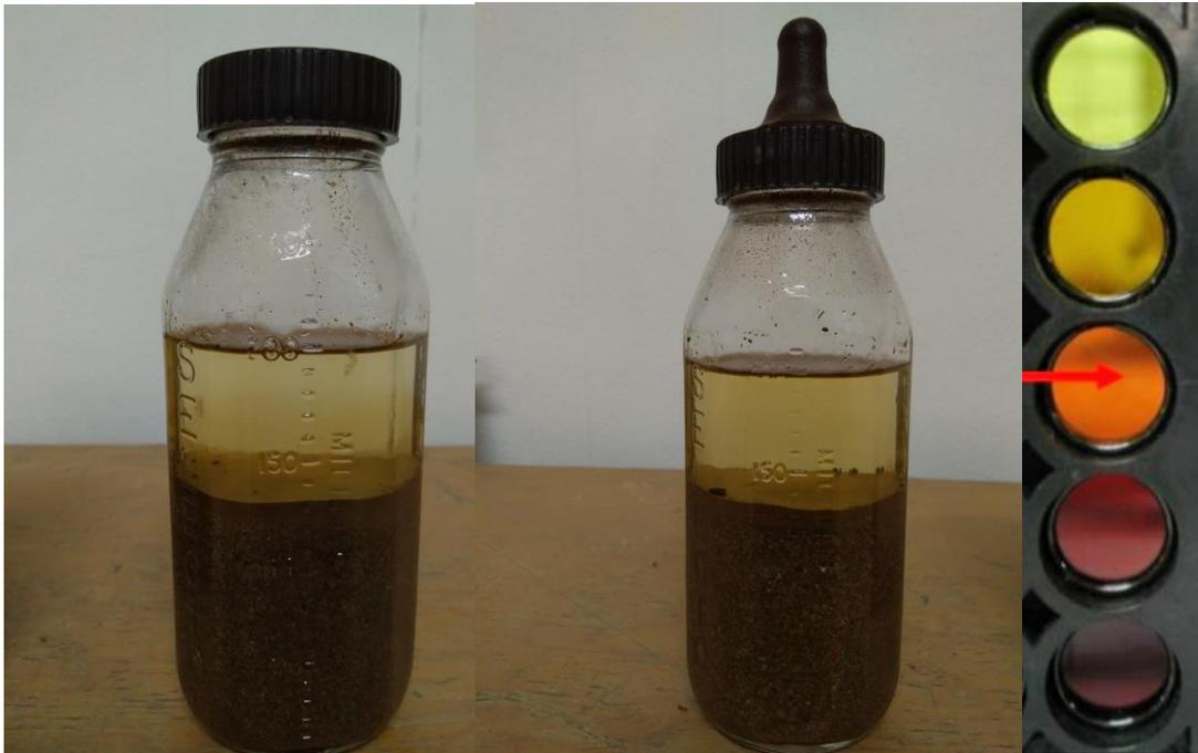
Figura 61. Comparación del patrón con tabla de colores.
