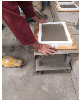
Figura.96. Vibración de 1ra. capa de la mezcla.
