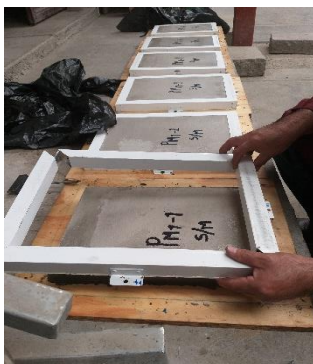
Figura.101. Desmolde del panel.
