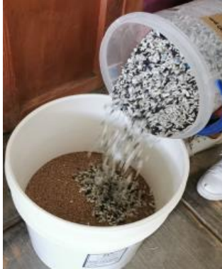
Figura. 53. Incorporación de RPAEE en la arena.
