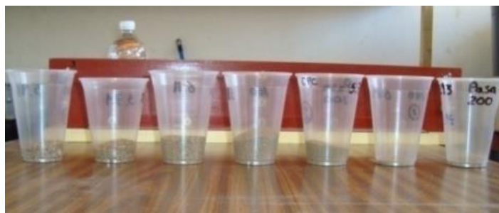
Figura.9. Retenidos en cada malla durante cribado. Fuente: DGAC,2022.
