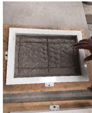
Figura.97. Colocación de malla en el molde.
