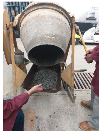
Figura.88. Toma de una muestra de la mezcla.
