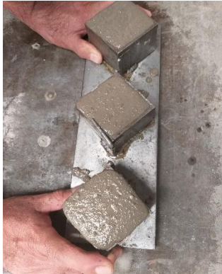
Figura.116. Vibración de 2 da. capa de mezcla.
