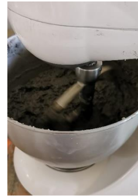
Figura.76. Mezclado de agua y cemento.
