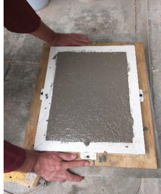
Figura.99. Vibración de 2da. capa de la mezcla.
