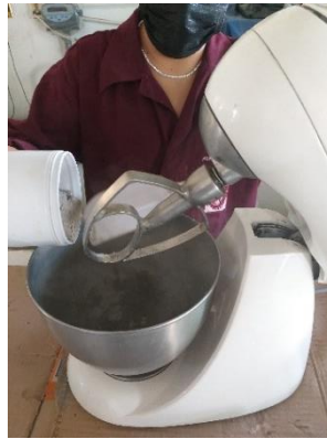
Figura.75. Incorporación del cemento.
