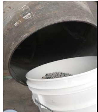
Figura.67. Colocación de RPAEE en la olla.
