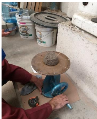
Figura.92. Realización de 25 golpes en mesa de fluidez.
