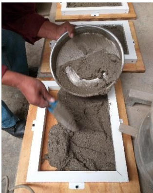
Figura.95. Colocación de 1ra. capa en el molde.
