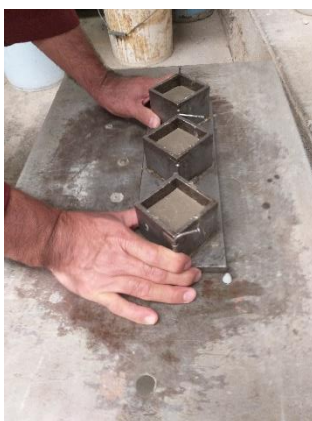
Figura.114. Vibración de 1ra. capa de mezcla. Fuente: DGAC,2022
