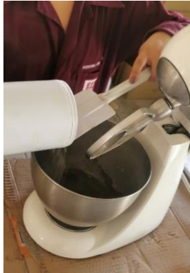
Figura.81. Incorporación de cemento al tazón.
