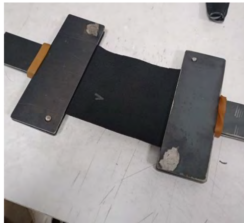
Figura 3.3 Muestra de tela montada en las mordazas.
