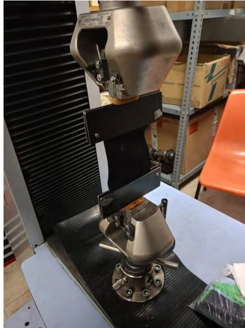
Figura 3.4 Muestra montada en la máquina Shimadzu.
