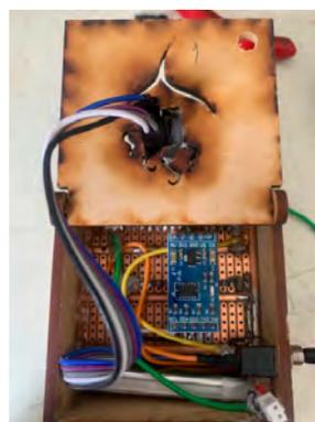
Figura 3.6: Estructura interna módulo de adquisición
