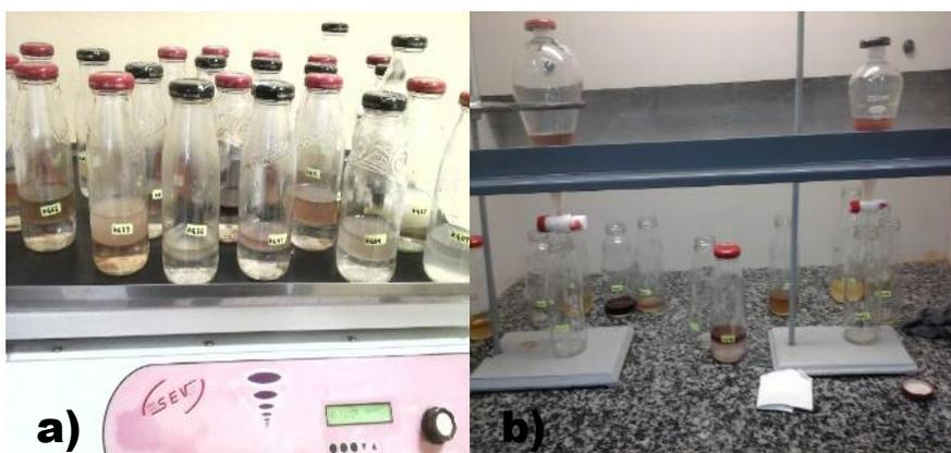
**Figura 3 :** *Tratamiento posterior de las fases biomasa-caldo para la obtención de los metabolitos: a) extractos obtenidos del caldo después de 22 horas de maceración en cloruro de metileno. b) Separación mediante decantación del cloruro de metileno y la película superficial.*
