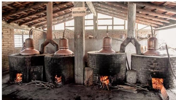
Ilustración 7 ALAMBIQUES DE COBRE PARA LA DESTILACIÓN DE MEZCAL.
