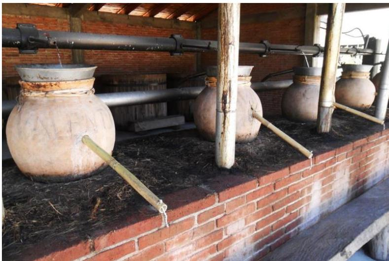
Ilustración 6 Ollas de barro para la destilación del Mezcal.
